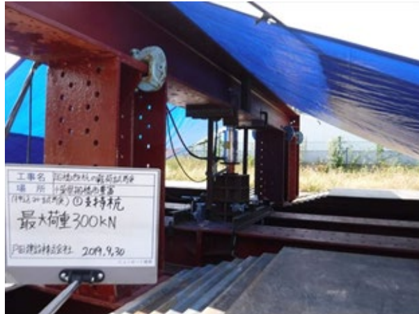
付図 1. 7 静的載荷試験：載荷状況
